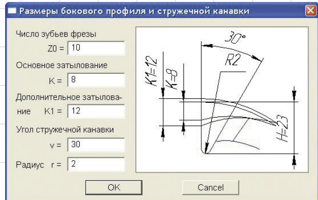
Рис. 3. Параметры бокового профиля зуба и стружечной канавки
