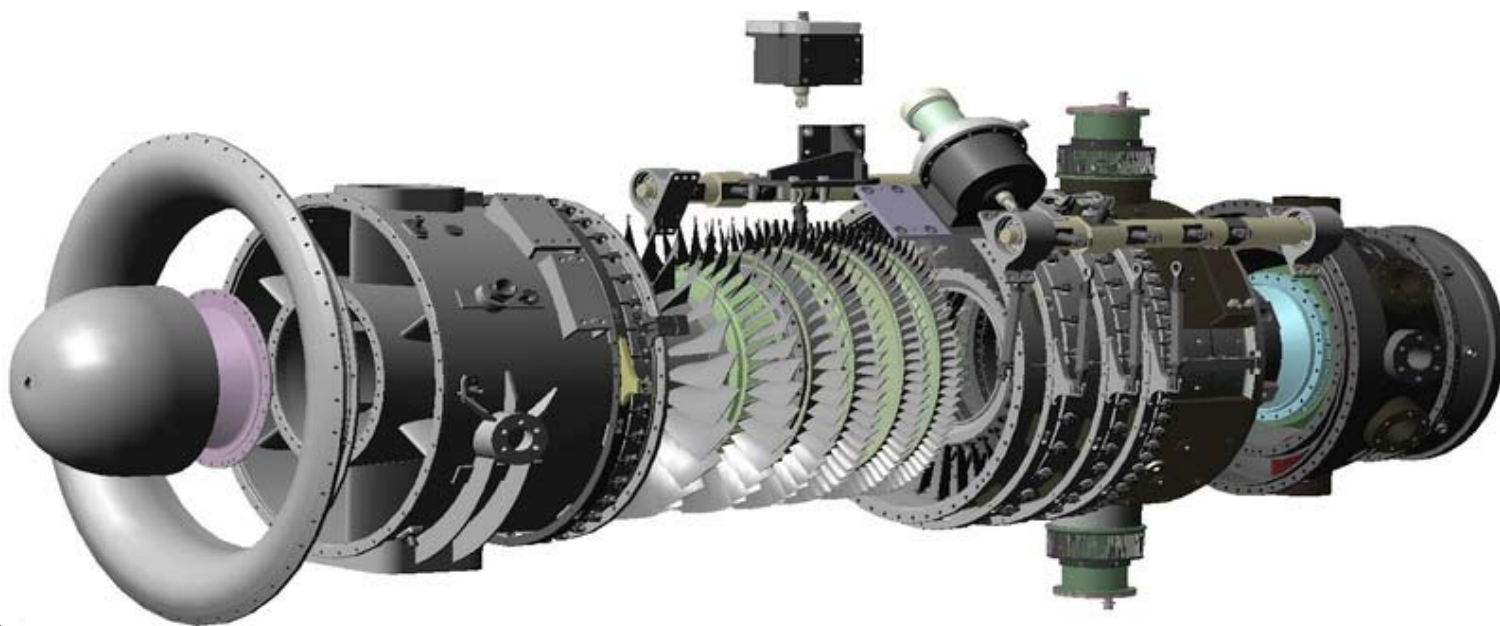
3D-модель компрессора низкого давления. Разнесенный вид
