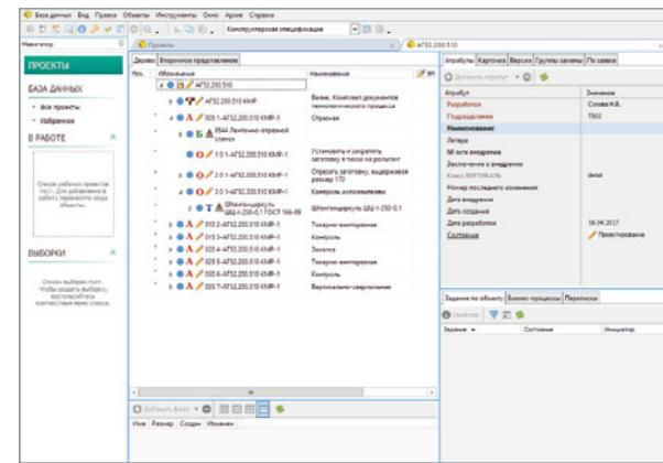
Аналогичная функциональность введена и для эффективной работы над технологическими процессами сборки: поиск элемента в составе сборки по его модели (изображению, позиции) и обратные действия — поиск элемента в 3D-модели (на сборочном чертеже) по данным о составе сборочной единицы. Кроме того, для полноценного и безошибочного описания операций в сборочном техпроцессе технологу предоставлены следующие функции:
